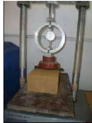
Figuras 5 y 6. Detalle de ensayos a compresión axial y flexión en BTC.
