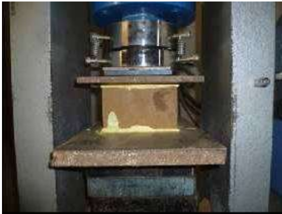
Figuras 5 y 6. Detalle de ensayos a compresión axial y flexión en BTC.
